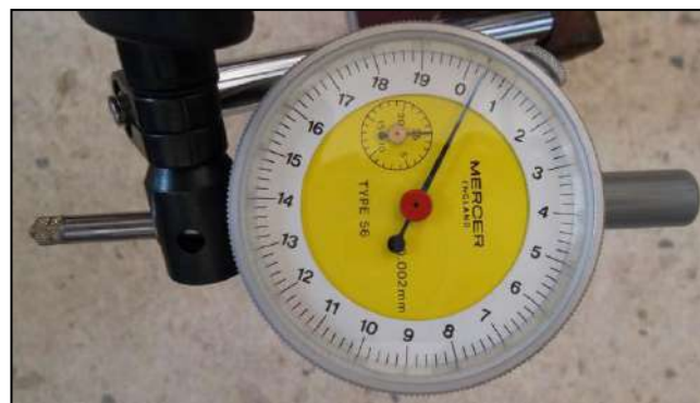
Photo 4.45 : Le comparateur utilisé
