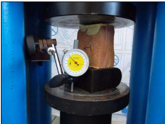
Photo 4.55 : Brique (01) dans la machine
