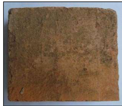
Photo 4.50 : Brique (02) après la coupe (115x45x95mm 3 )
