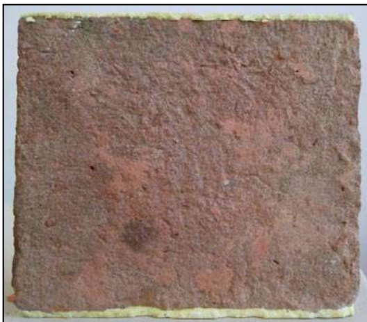
Photo 4.69 : Détachement de couches
