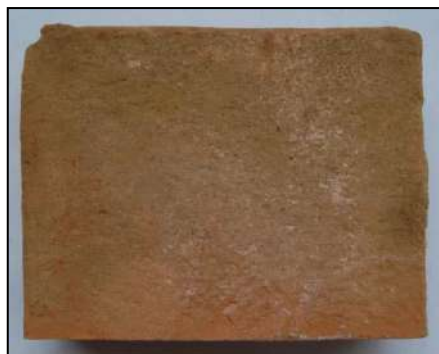
Photo 4.51 : Brique (03) après la coupe (120x45x95mm 3 )
