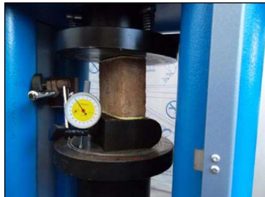
Photo 4.56 : Brique (02) dans la machine
