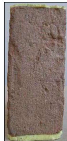
Photo 4.70 : Petites fissures longitudinales
