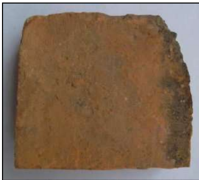
Photo 4.49 : Brique (01) après la coupe (85x50x95mm 3 )
