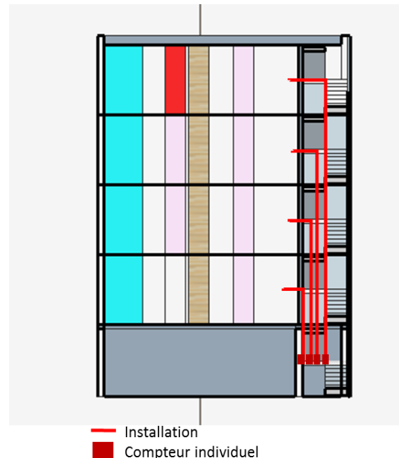
Figure 35 : Coupe schématique de l'installation d'eau et du gaz dans l'immeuble, développée par l'auteur
