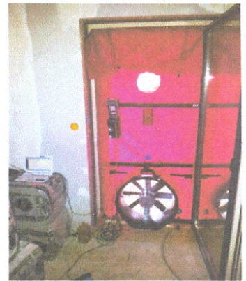
Fig. 25 : Test d'étanchéité à l'air
