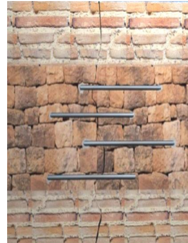
Figure 34 renforcement par des agrafes métallique
