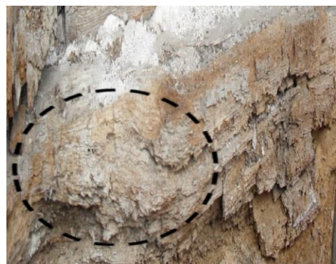
Figure 11 Pourriture blanche cause de dégradation et de perte de résistance du bois
