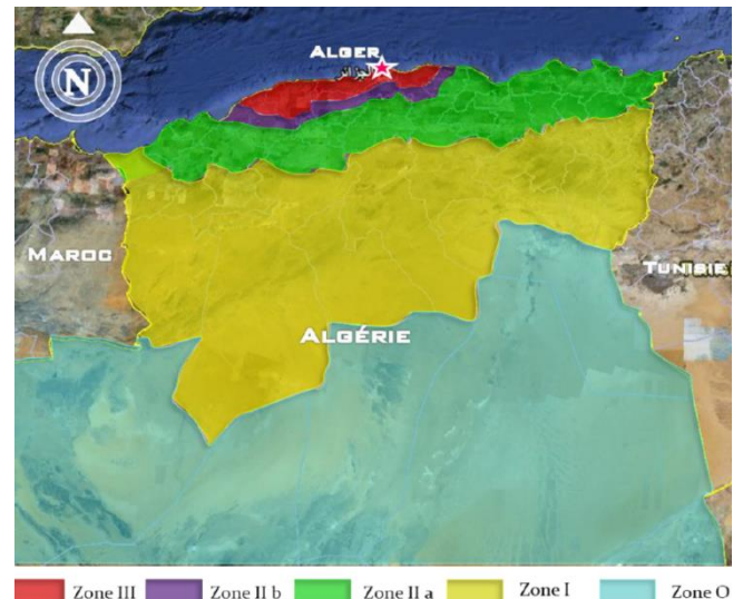
Figure 5 carte 3 : zonage sismique en Algérie Source : Auteur en référence du RPA99 version (2003)/ APRES
