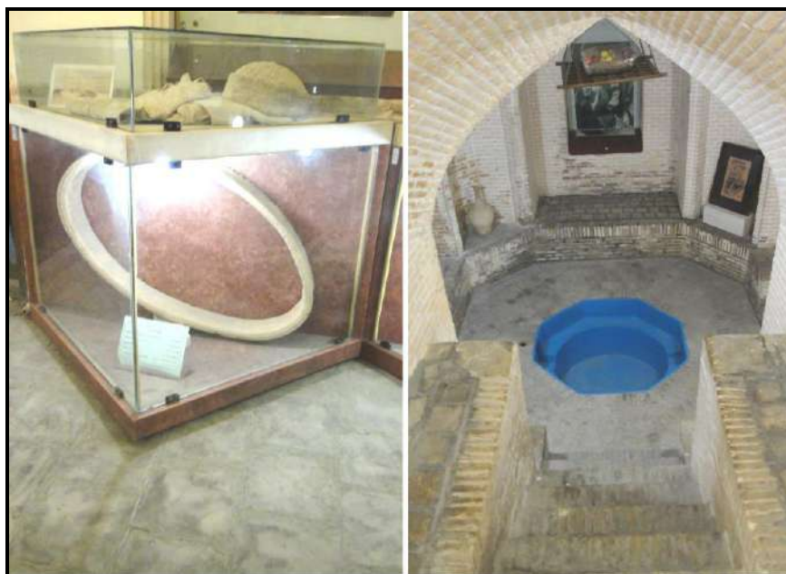
Fig. 20 _ Musée de l'eau à Yazd (Iran), à gauche, un exemple de kaval pour chemiser les galeries. A droite un payab pour l'alimentation urbaine en eau. Photo : Septembre 2010.
