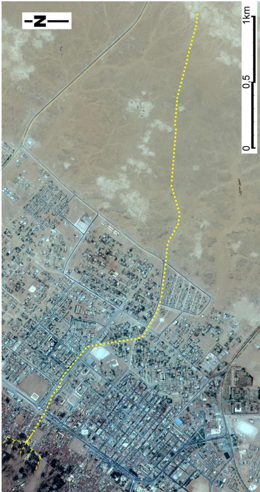
Carte 17 _ Tracé de la galerie de la foggara Amekane. Restitution du relevé effectué en mars 2012 sur photo aérienne G-map-2012
