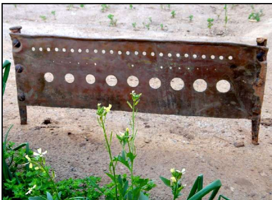
Fig. 77 _ Dernière hallafa utilisée dans la mesure des parts d'Amekane. Lors du jaugeage, la plaque doit coller au sol et l'eau passer par les orifices laissés ouverts sans déborder. La somme des surfaces de ces orifices constituent la mesure totale de la part effective ( M'zekki ) en question.
