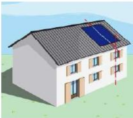
Figure (23): Installation du capteur sur une toiture inclinée respectant l'axe de la fenêtre ( source: solaire thermique: chauffage et chauffe eau, consulté le 23 aout 2015, http://www.energiesfluides.fr/Solaire-thermique.html )
