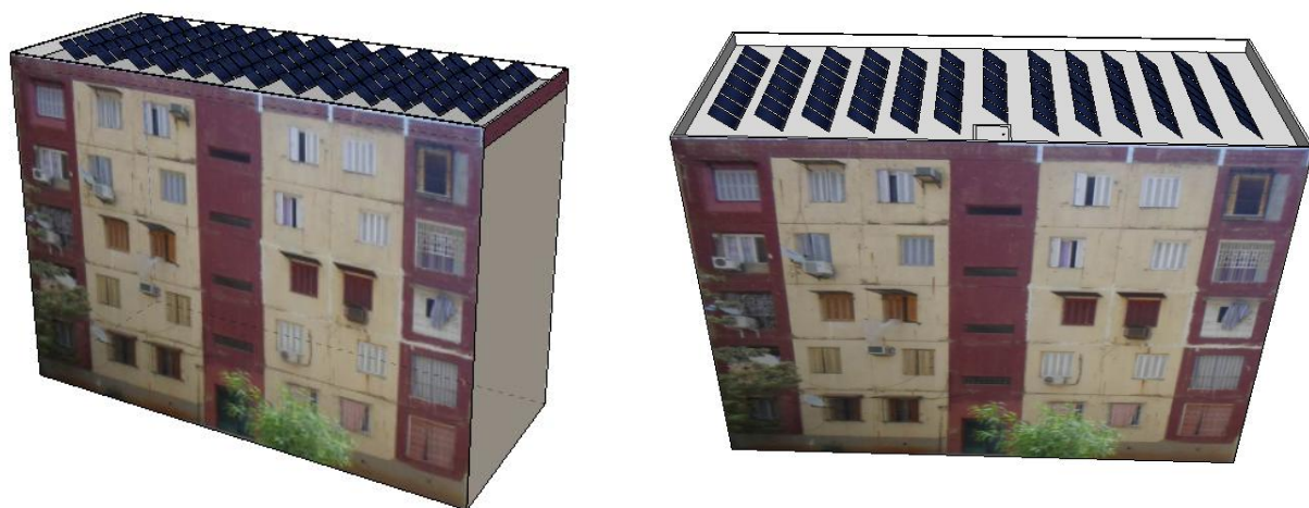
Figure (53): L'emplacement des capteurs solaires sur la terrasse du bâtiment (source: auteur)
