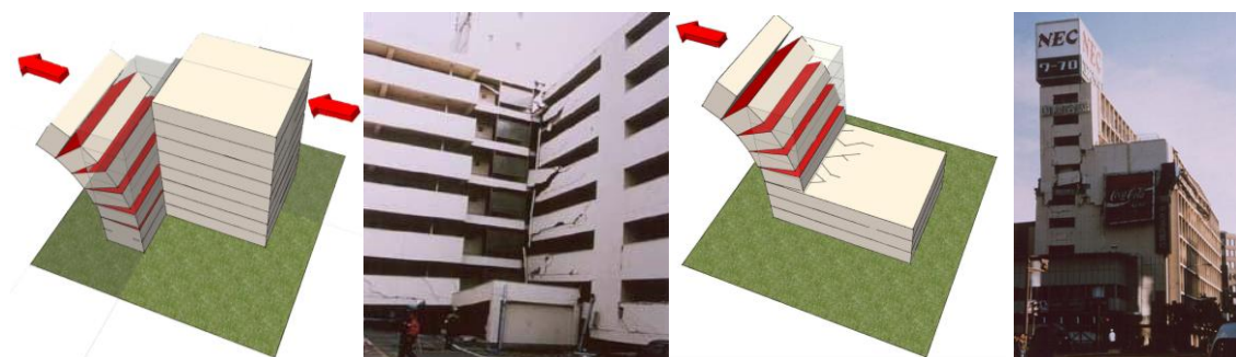
Fig. 28 : Oscillation non synchronisée entre deux entités d'un bâtiment ayant des proportions différentes. Exemples : séisme de Kobé, Japon 1995. (Crédit photo : Djennane W., [Zacek M., 2004]).
