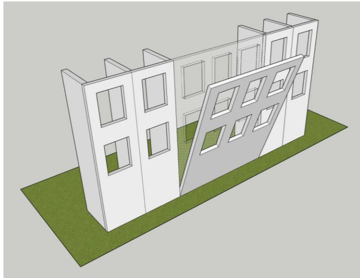
Fig. 14 : Basculement dû à une grande portée. (Crédit photo : Djennane W.)
