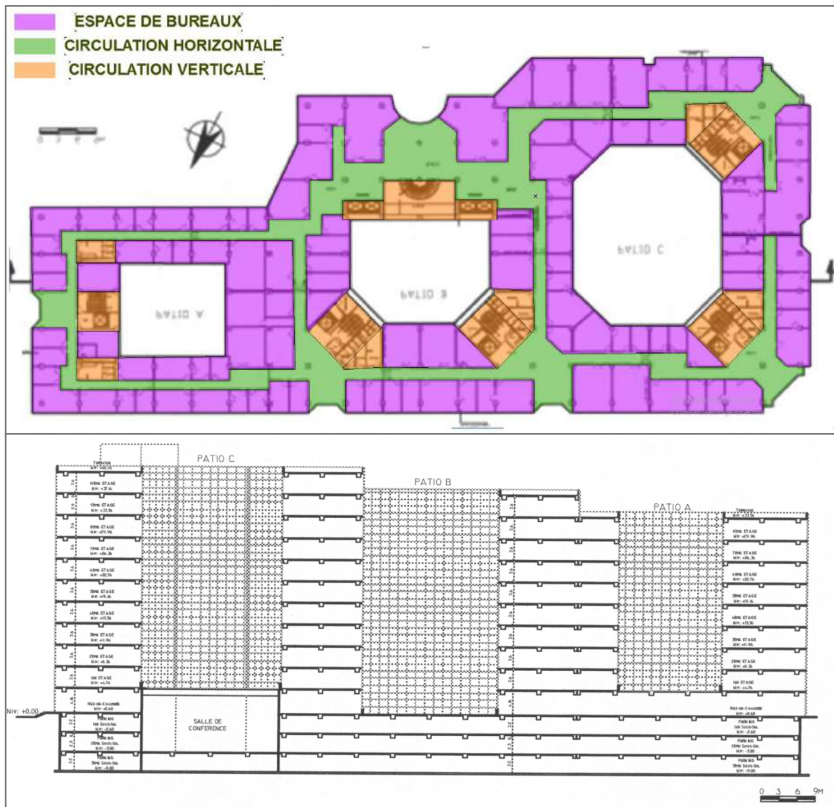
Figure 47 : Plan d'étage courant et coupe longitudinale sur l'édifice de la SH (Chabane, 2006, p. 76)
