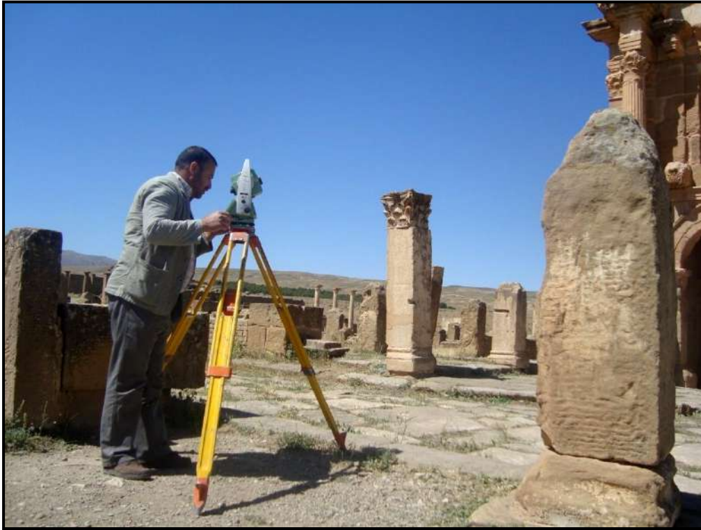
Figure 67: relevé avec station leica de l'arc de Timgad, Source: Photo prise par l'auteur, Mai 2014.
