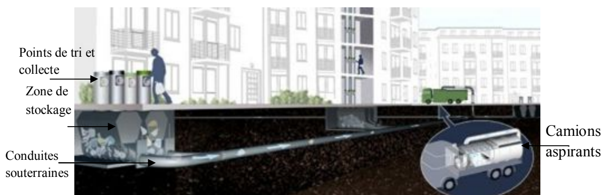
Figure II- 37 : Collecte pneumatique des déchets dans l'Eco-quartier Fort d' Issy à Issy les Moulineaux
