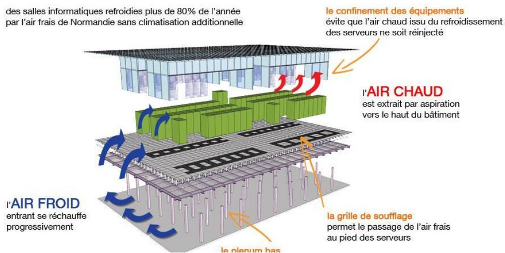
Figure 44 : Système de fonctionnement de free cooling au sein de Normandie (Source : Orange, 2013)
