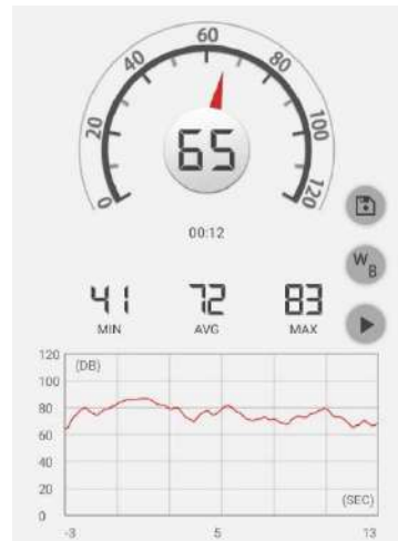
Fig.n°51:Mesure d'intensité au niveau de public (les dernières rangées) Source : auteur
