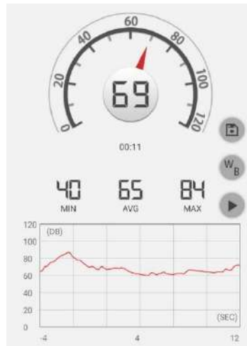
Fig.n°50:Mesure d'intensité au niveau de public (les premières rangées) Source : auteur
