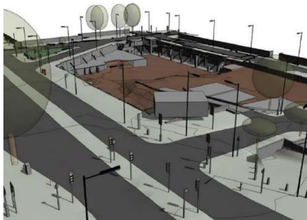
Figure 49: Modéliser une maquette topographique BIM à partir d'un relevé au scanner laser.
