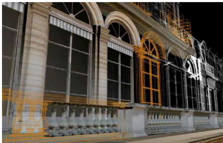
Figure 47: Résultats de la modélisation présentant le nuage de points, le modelé texturé et le modèle filaire
