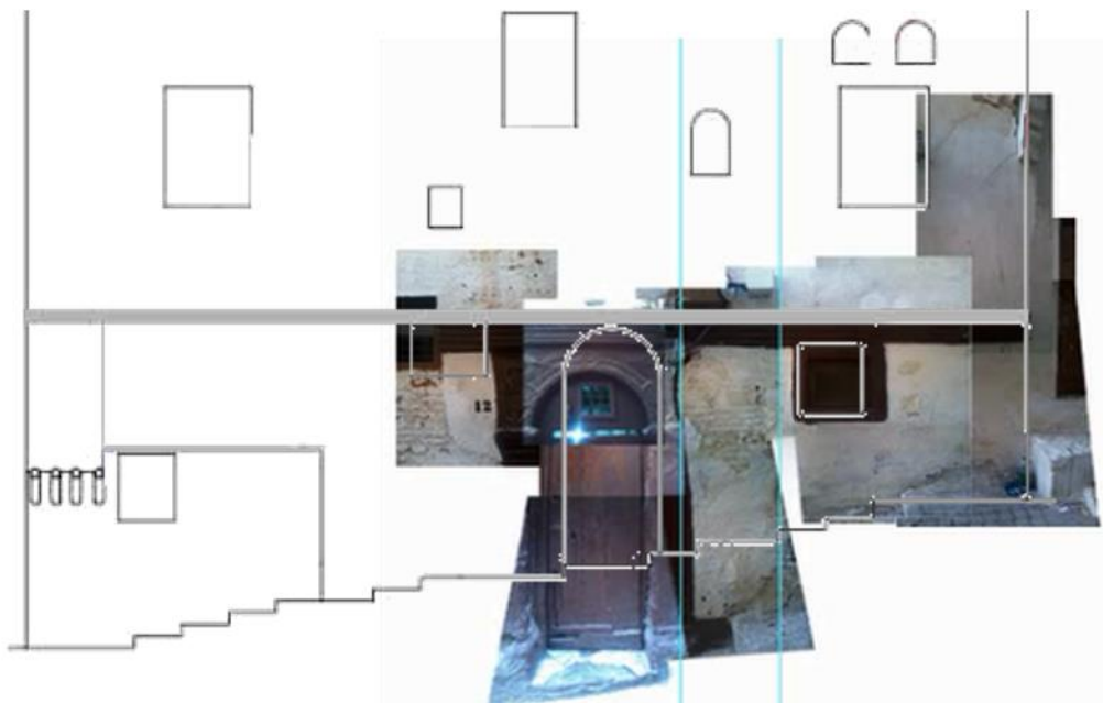
Figure 56 : Comparaison de la façade reconstituée par panorama et la façade technique du PPSMVSS
