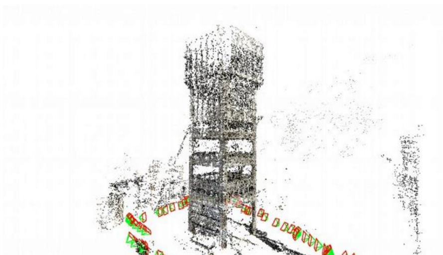
Figure 9 : Une empreinte numérique photogrammétrique par nuage de points, générée suivant le protocole d'acquisition
