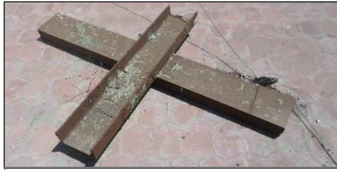
Figure 4.68 : IPN 200 utilisés dans le chainage
