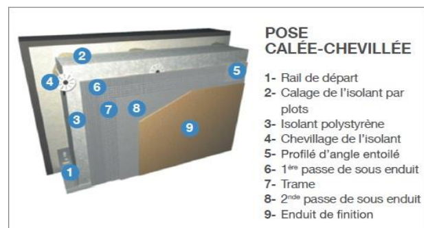
Figure 27 : Illustration représentant la pose calée-chevillée d'une isolation thermique extérieure sous enduit. (source : Point.P (4 février 2014). L'isolation thermique des murs par l'extérieur (ITE). [en ligne]. http://www.pointp.fr/l-isolation-thermique-des-murs-par-l-exterieur-ite-XA163 [Consulté le: 10 septembre 2017].)
