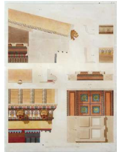
Illustration 04-2 Restitution en couleur d'une partie de l'entablement et de la couverture d'un temple par J.I.Hittorff
