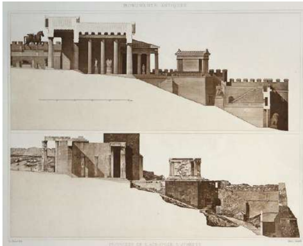
Illustration 04-1 Coupe longitudinale des propylées de l'acropole d'Athènes : Etat des lieux et proposition de restitution par Boitte
