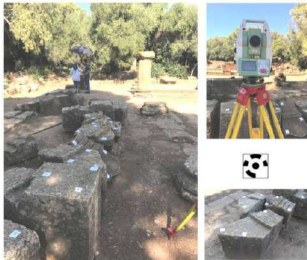
Relevé des blocs en utilisant des cibles fournies par le logiciel de modélisation
