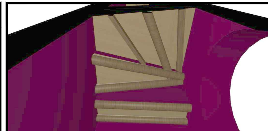
N°13 :détail de la structure du balancement de l'escalier .
