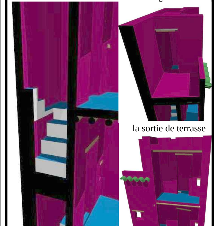
le palier de repos et les marches vers la terrasse
