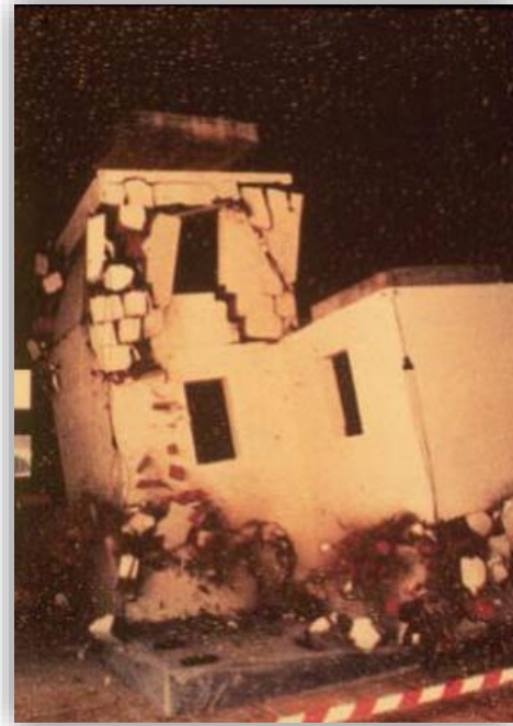
Figure 4.3 : maquette de maçonnerie sur table vibrante.
