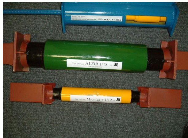
Figure 6.10 : amortisseur (raidisseur vertical). Source : site officiel entreprise DC 90.
