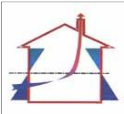
Figure 4: effet du tirage thermique, (Roulet, 2010)
