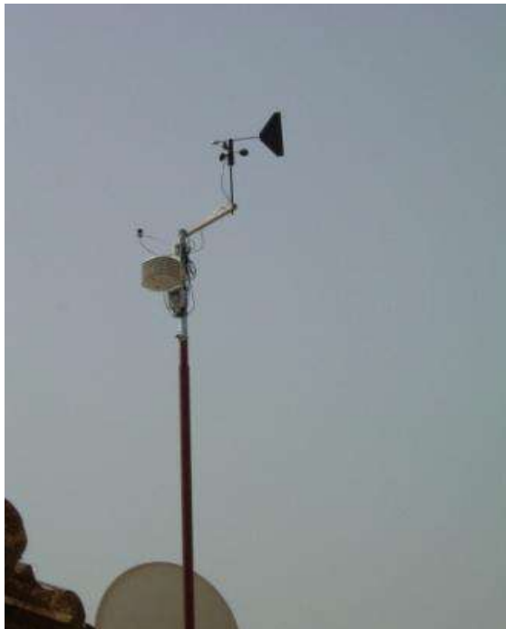
Photo 38 : Dispositif HOBO en terrasse, (Photo : Auteur)
