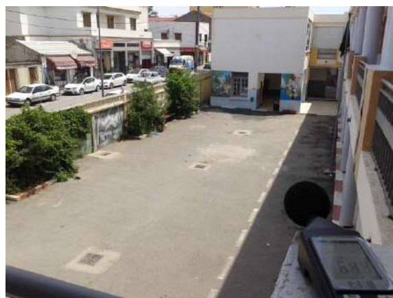
Figure 36 : prise de mesure à un point de la coursive.
