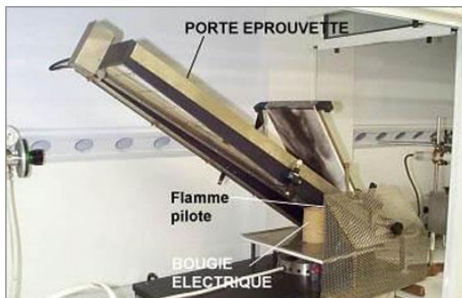
Fig. 48: Essai de résistance au feu.
