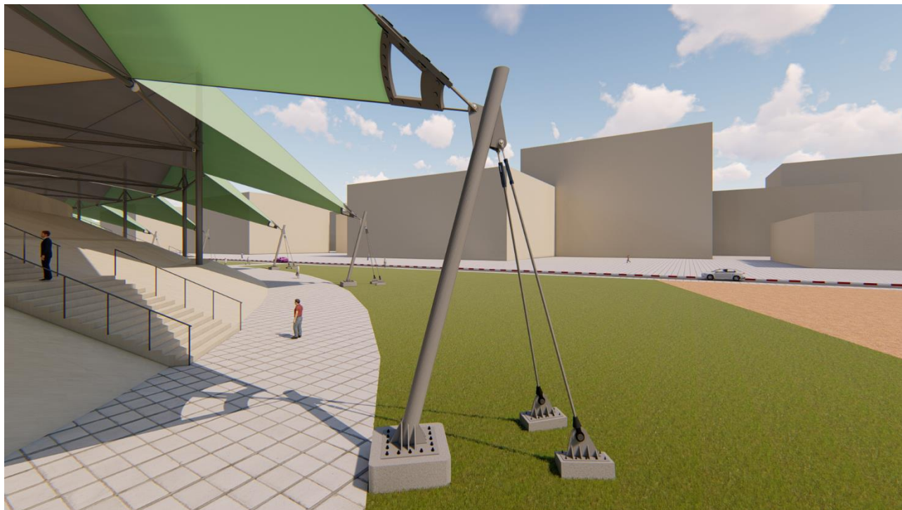
Fig. 161 : Vue sur élément structurel. Le mat secondaire
