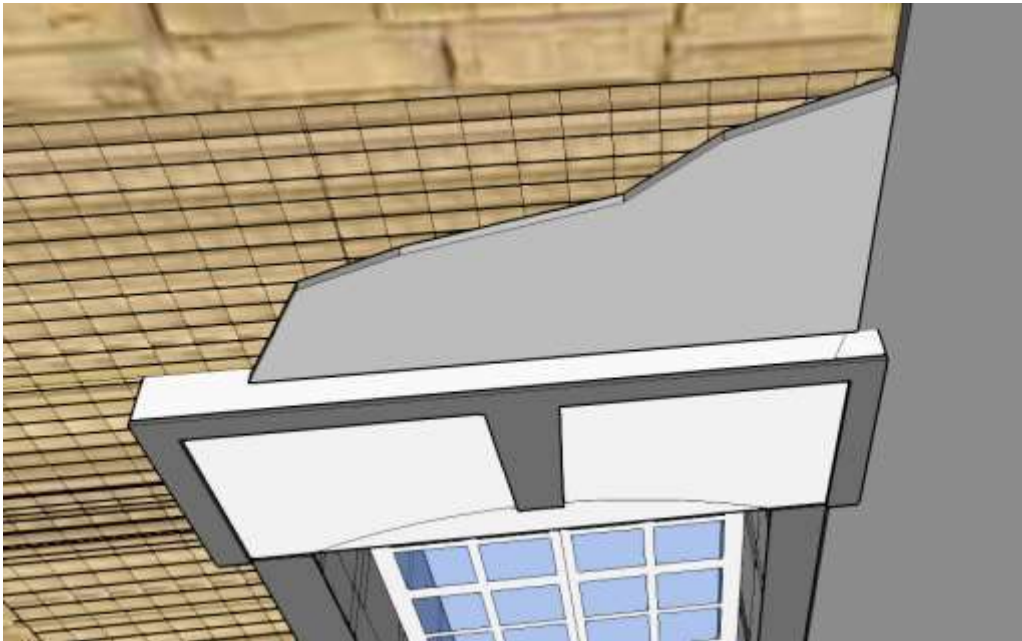
Fig. 4.167: Reprise de la différence de niveau dans la façade par un enduit grillagé de deux couches
