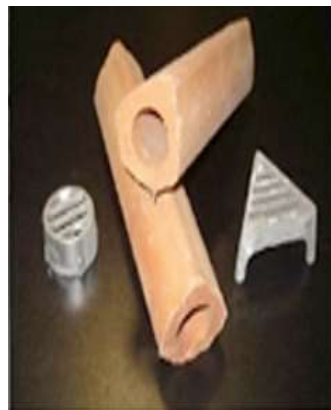
Fig. 3, 86 : les siphons en terre cuite employés dans le procédé de Knappen Source : M.Idir, CNERIB 2010
