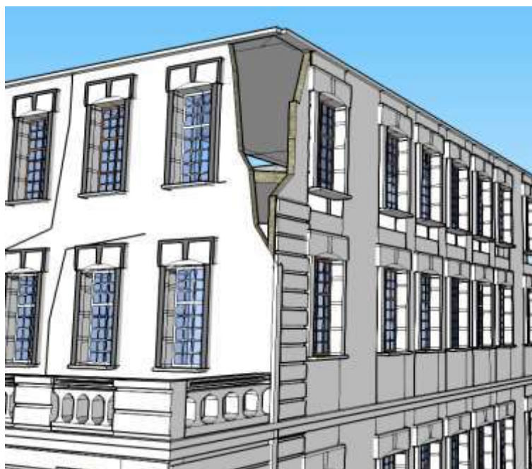
Fig. 4.150 : Dislocation au niveau des angles due à l'absence des chainages d'angle.
