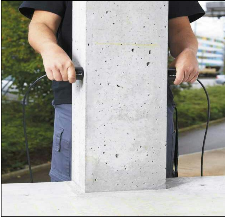
Photo.25. Utilisation d'un pachomètre. Source : www.archiproducts.com .
