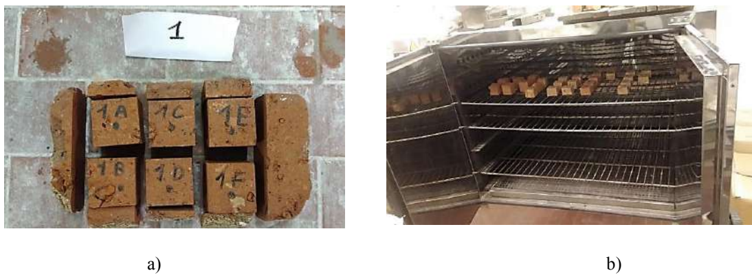
Fig 4.2.6 a) Troisième étape : insertion des références, b) quatrième étape : séchage au four (Source : auteur)
