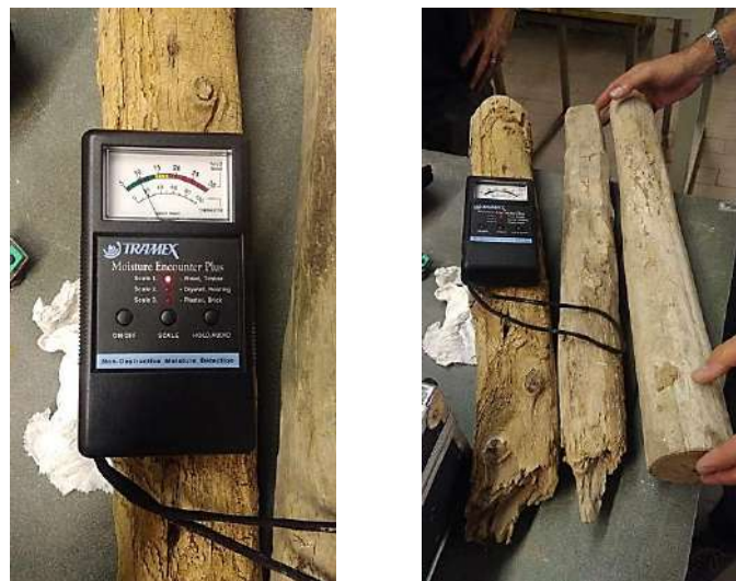
Fig 4.4.1 Application du capteur d'humidité ( Capacitivo ) (Source : auteur)
