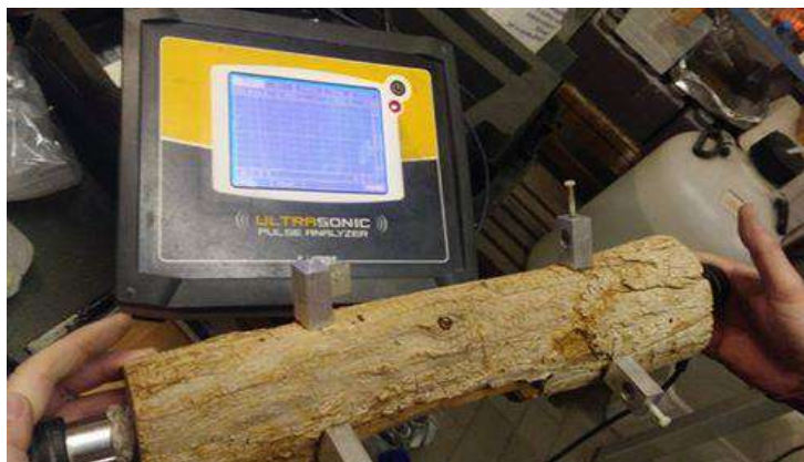
Fig 4.4.3 Application du test ultrasonique sur le bois de Thuja (Source : auteur)
