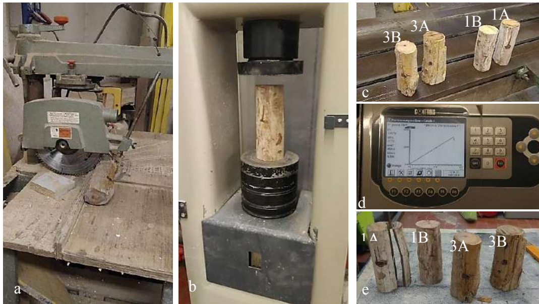
Fig 4.2.28 Processus d'obtention de la résistance à la compression du bois de Thuja (Source : auteur)
