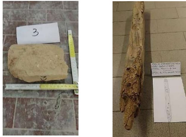
Fig 4.2.3 Préparation des échantillons, première étape : analyse visuelle, (prise de mesures à gauche, croquis à droite) (Source : auteur)
