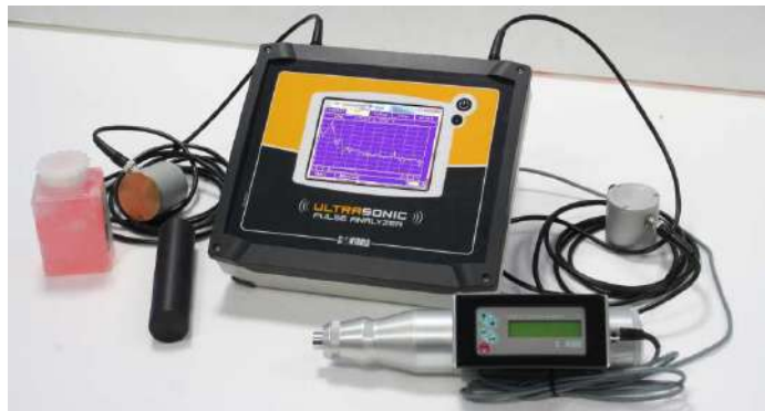
Fig 4.4.2 Composition de l'appareil à ultrasons (Source : auteur)
