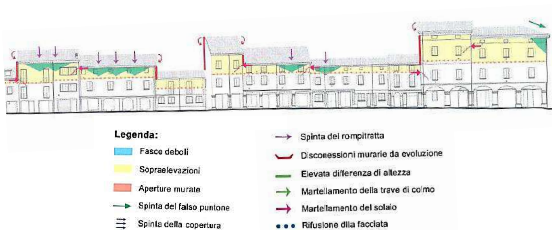
Fig 1.2.8 Exemple de représentation des mécanismes d'endommagement activables. (Source : (Mochi, et al., 2016))
