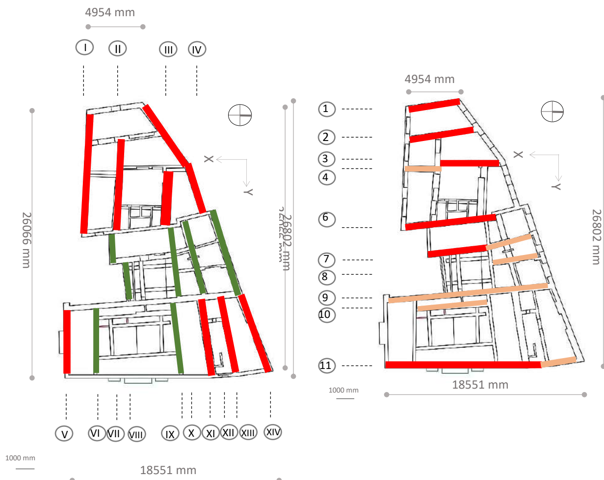
Fig 5.3.9 Murs vulnérables le long des axes X et Y (Source : auteur).
