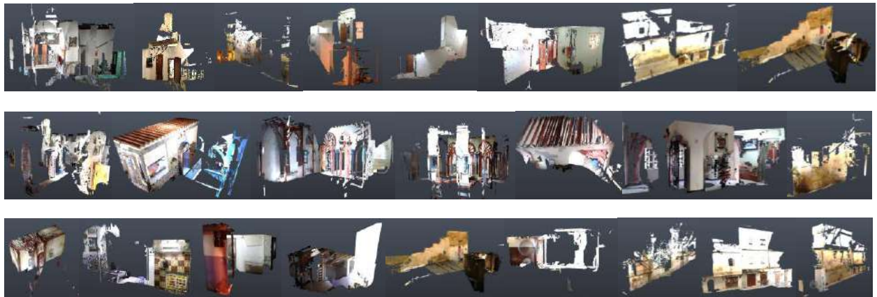
Fig 2.3.2 Différents scans après nettoyage et avant assemblage, un exemple de 24 scans (Source : auteur).
