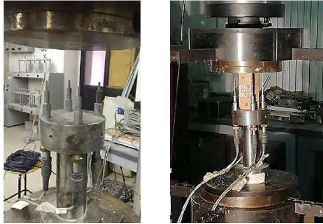
Fig 4.2.12 Positionnement des cubes dans la machine d'écrasement (Source : auteur)
