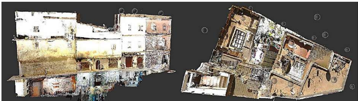
Fig 2.3.4 Nuage de points final de l'agrégat obtenu après nettoyage et assemblage. (Source : auteur).
