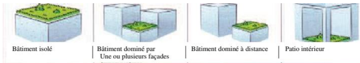
Figure II- 1 : Différentes configurations d'un toit végétal
