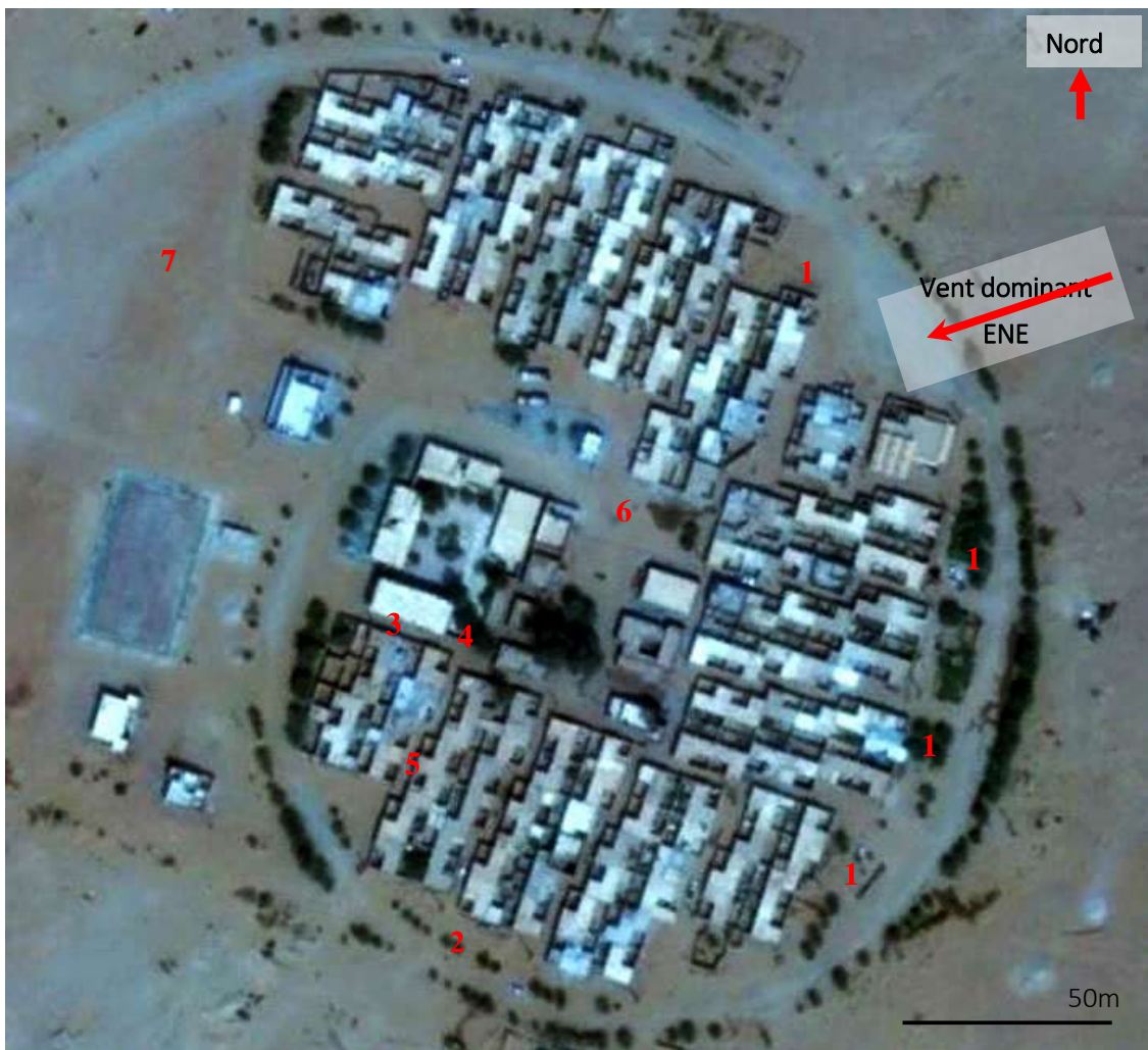
Figure 156: identification des zones de dépôt sur le plan masse du village de M'guiden. Source : Auteur
