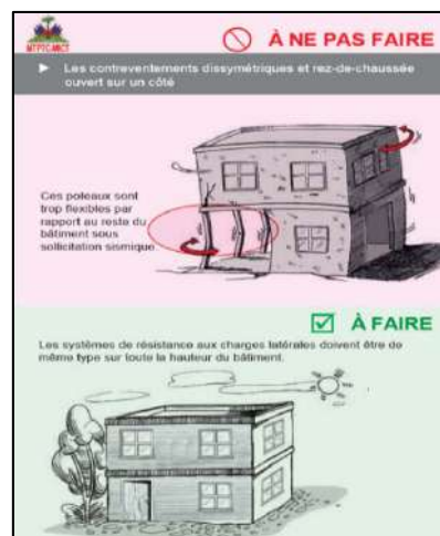
Figure 25 : éviter la mauvaise distribution de la rigidité au niveau de plan. Source : (MTPTC & MICT ,2010)
