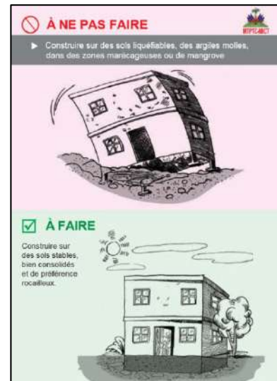
Figure 22 : ne pas construire dans les zones marécageuses Source : (MTPTC & MICT ,2010)
