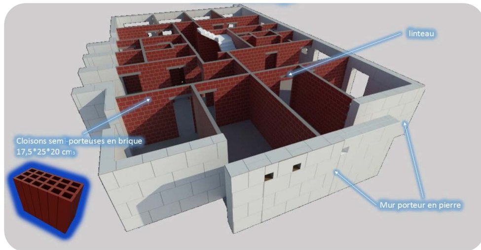
Figure 223 : la structure de l'étage courant
