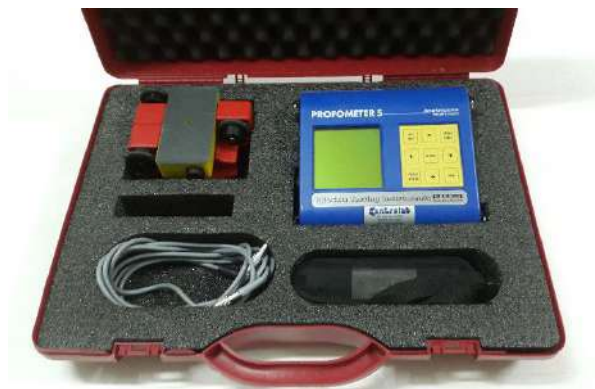
Figure 273 : le détecteur d'armature utilisé Photo prise décembre 2015
