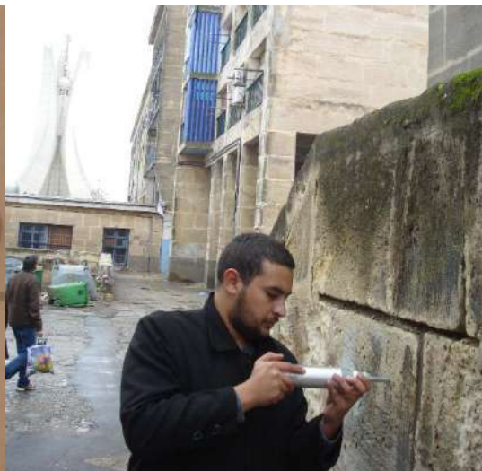
Figure 272 : les essais en utilisant le scléromètre Photo prise décembre 2015
