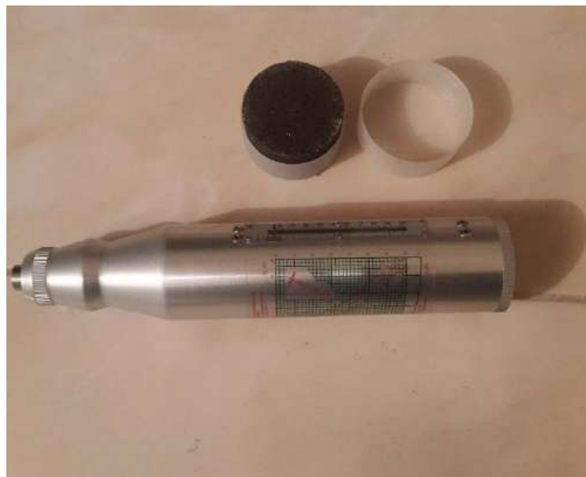
Figure 271 : le scléromètre utilisé Photo prise décembre 2015
