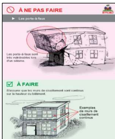
Figure 24 : il faut éviter les portes à faux Source : (MTPTC & MICT ,2010)
