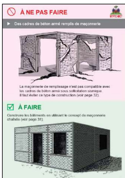
Figure 26 : la maçonnerie chaînée tout en assurant une bonne connexion entre le béton armé et le mur porteur. Source : (MTPTC & MICT ,2010)
