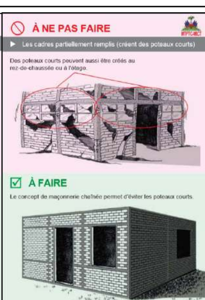
Figure 28 : poteaux courts au niveau des ouvertures
