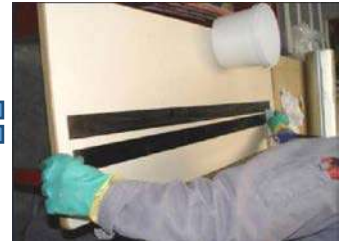
Figure 46 : plats métalliques collées Source : ( Attari.N; 2013)
