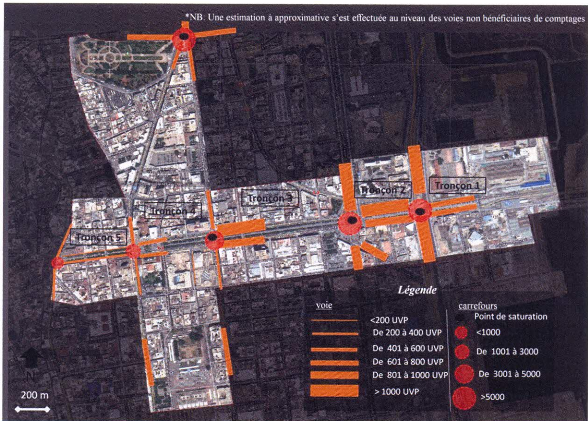
Schéma 4 - Quantification des flux à l'intérieur du périmètre et localisation des carrefours saturés
