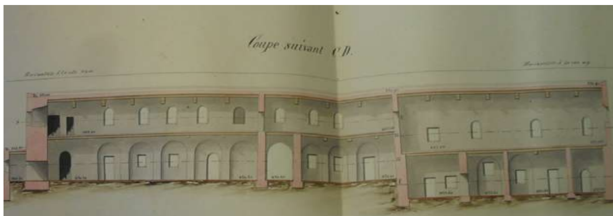
Fig.5. Coupe sur l'ancienne galerie à arcade. Extraite du plan de 1848. (SHAT., 1VH 1315, feuille n°3)
