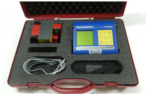
Figure 273 : le détecteur d'armature utilisé Photo prise décembre 2015
