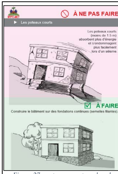
Figure 27 : poteaux courts en bas de construction
