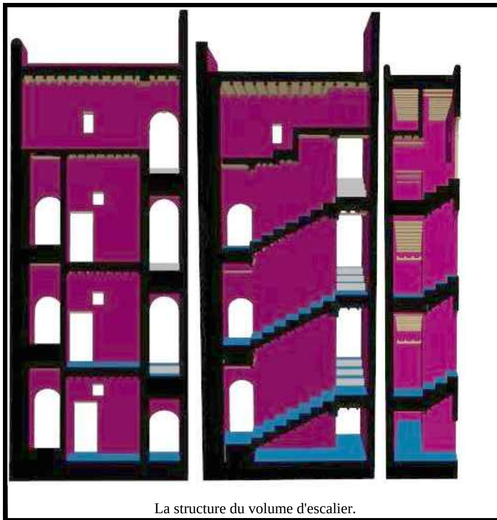
Schéma de la structure du volume d'escalier.
