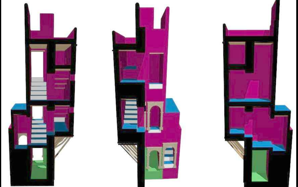
La structure du volume d'escalier.
