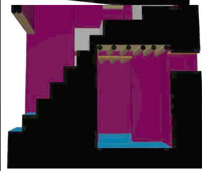
La première volée d'escalier
