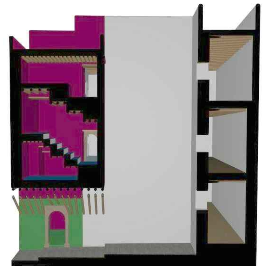
Coupe longitudinale sur l'ensemble de la maison.
