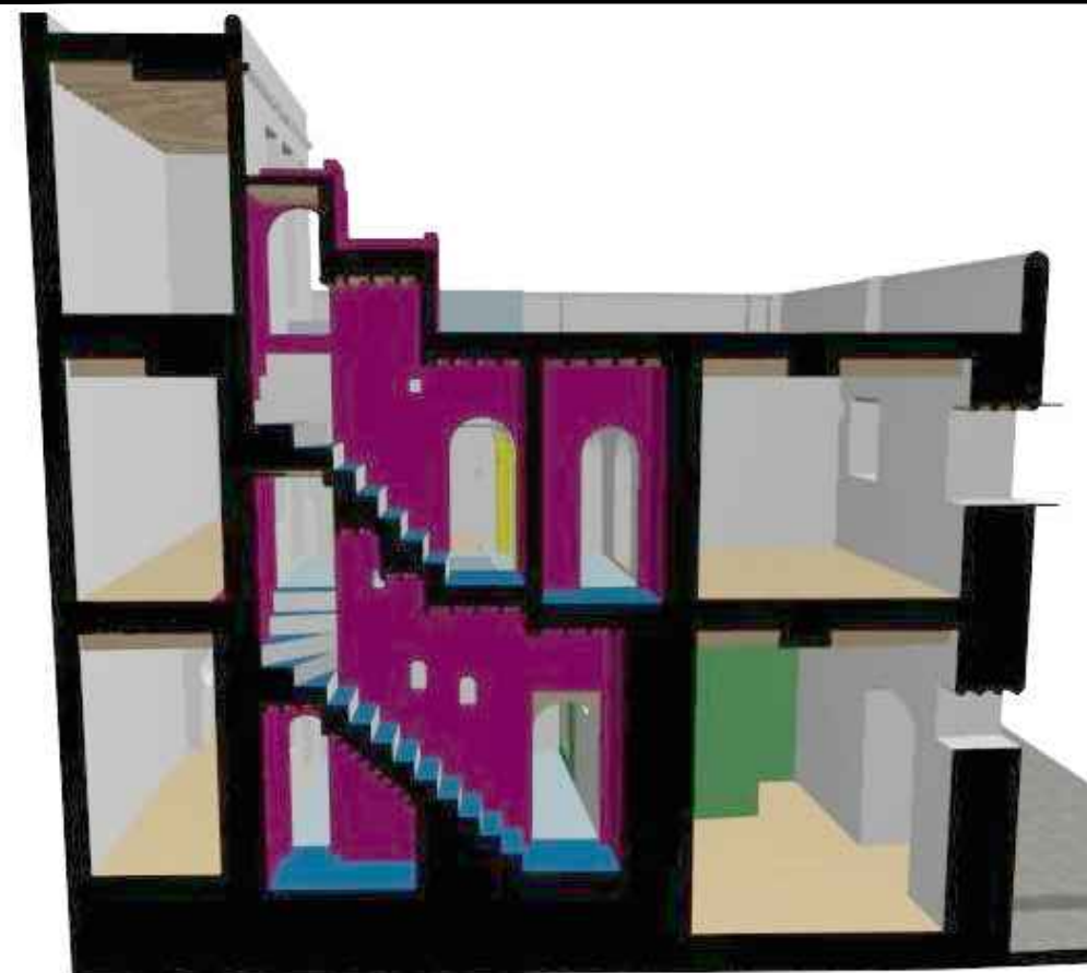
Coupe longitudinale sur l'ensemble de la maison.
