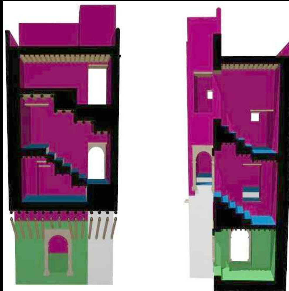
La structure du volume d'escalier.
