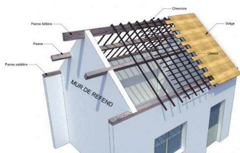
Figure 21: Charpente sans ferme.
