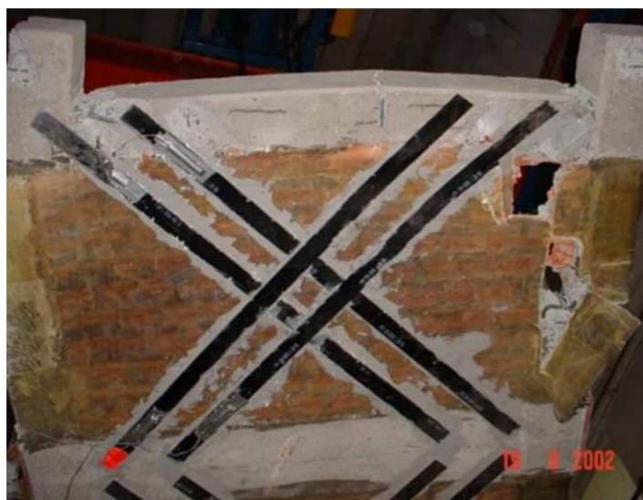
Figure 122: Consolidation par des fibres de carbone
