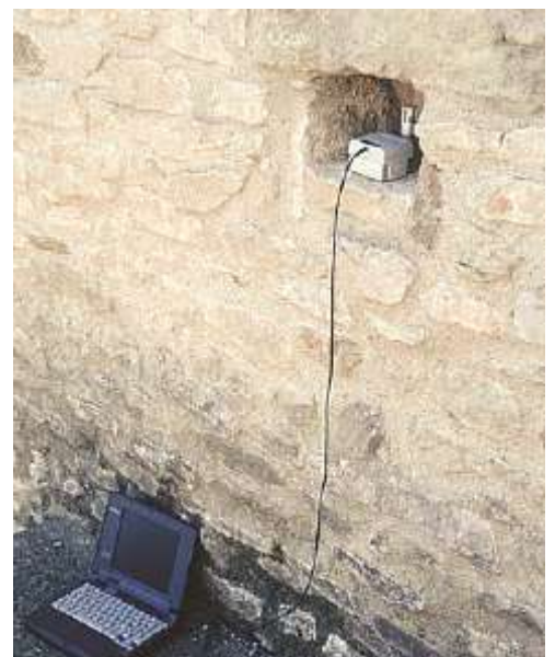
Fig. 24 : L'analyse de l'humidité, l'emploi de différents genres d'hygromètres
