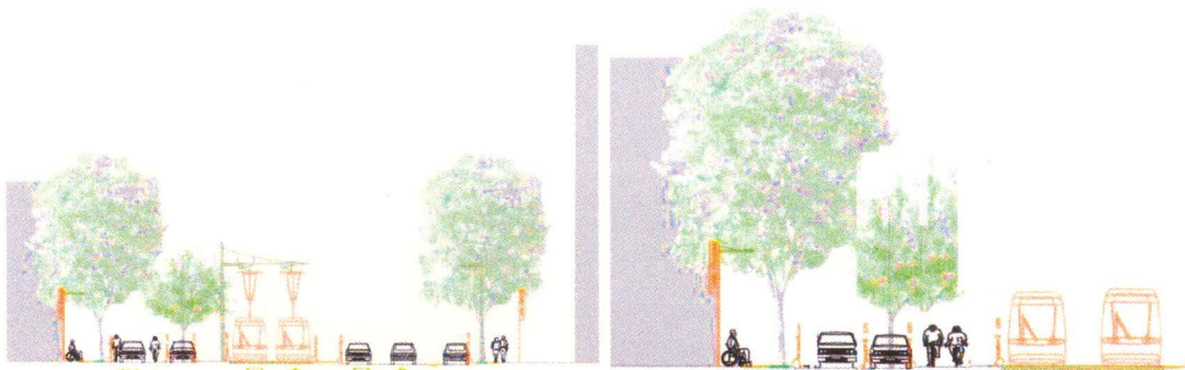
Figure 39: Schémas types de disposition du tramway en milieu urbain
