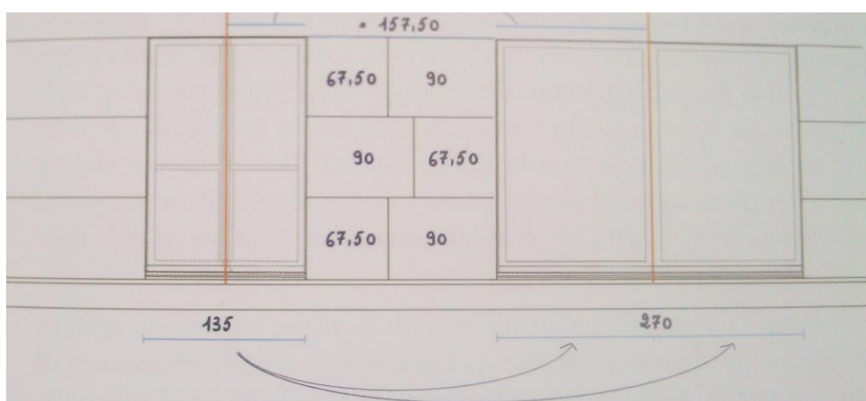
Figure 32 : Dimensions de la pierre (source : CATHERINE SAYEN, 2015, p 79)
