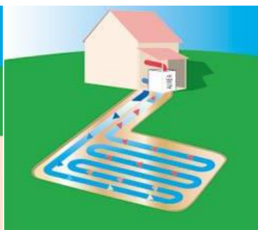
Figure 28: Capteur horizontal, géothermie. Source: Web.
