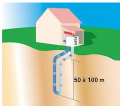
Figure 27: Capteur vertical, géothermie. Source: Web.
